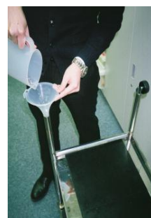
図 3. 支柱に砂利を詰める
