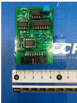
図1 マルチチャネル表面筋電図用アンプ
