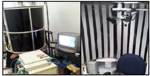
図1 視覚性動揺病を誘発させる optokinetic drum 直径76cm、高さ91.5cmのdrumで、内部には白黒の縦のストライプが交互に描かれている。drumの中央に被験者を座らせ、テレビモニターにて監視をしながら時計回りに60°/secの速さでdrumを回転させると視覚性動揺病を誘発させる。
